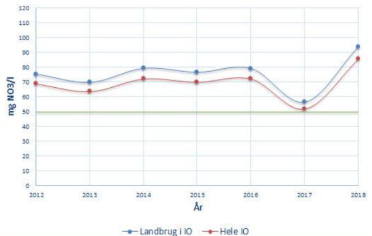
Figur 5. Beregnet gennemsnitlig kvælstofudvaskning i perioden 2012-2018 i indsatsområdet fra hhv. landbrugsarealer (blå) og hele arealet (rød).
